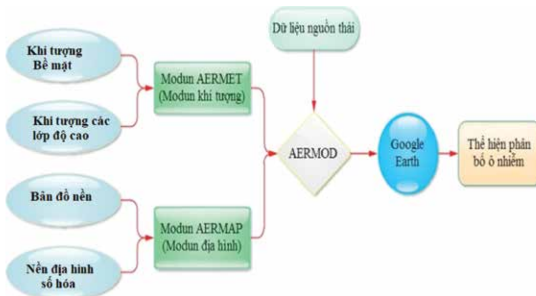
▲ Hình 2. Cấu trúc mô hình AERMOD
